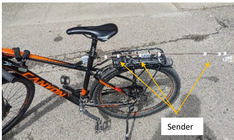
Abbildung 8: mögliche Befestigung der Sender für die Testaufzeichnung
