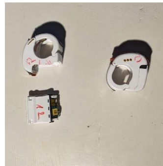
Abbildung 7: Der Skyleader GPS-Tracker, zusammengesetzt und Ring von Akku getrennt
