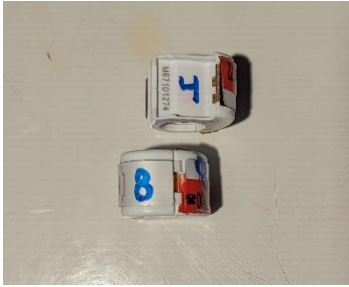
Abbildung 9: empfohlenes Anschreiben der Tracker, 1x aussen, 1x auf Steck- platz für Akku
