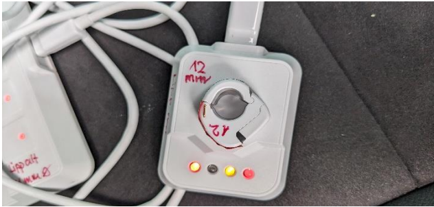
Abbildung 13: Tracker-Programmier- & Auslesegerät, hier beim Programmieren der Startzeit
